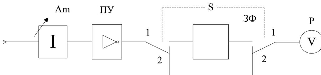
Рисунок 2 – Упрощенная структурная схема измерителя нелинейных искажений С6-5
