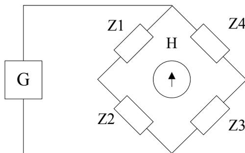
Рисунок 1- Обобщенная схема измерительного моста переменного тока
