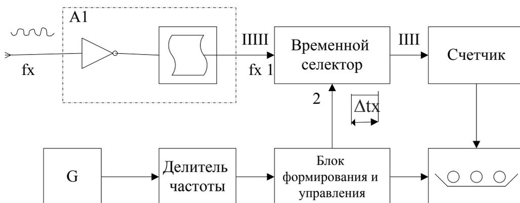
Рисунок 1 – Структурная схема цифрового частотомера
