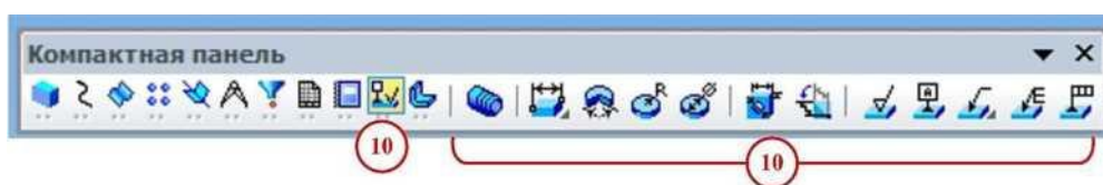
Рисунок 14 Инструментальная панель Элементы оформления - кнопка вызова панели Элементы листового тела 11 , рисунок 15, на которой расположены кнопки вызова команд построения листового тела и листовых элементов;
