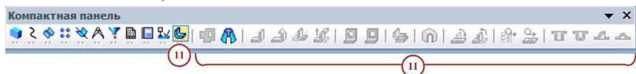
Рисунок 15 Инструментальная панель Элементы листового тела Наличие черного треугольника в правом нижнем углу кнопки любой панели программы свидетельствует о наличии расширенной панели ин-
