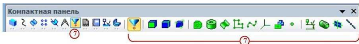
Рисунок 12 Инструментальная панель Фильтры - кнопка вызова панели Спецификация 8 , рисунок 13, на которой расположены кнопки вызова команд работы со спецификацией;
