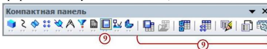
Рисунок 13 Инструментальная панель Отчеты - кнопка вызова панели Элементы оформления 10 , рисунок 14, на которой расположены кнопки вызова команд простановки размеров и создания условных обозначений на детали;
