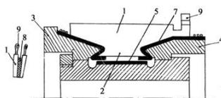
В два конусообразных углубления коллектора вставляются изолированные нажимные конусы 3, 4, которые стягивают коллекторные пластины в осевом направлении. В
