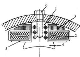
1 - сердечника и катушек обмоток возбуждения. По отношению к обмотке якоря обмотки возбуждения могут включаться параллельно или последовательно;
