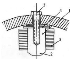
тушка изготавливается из полосовой меди большого сечения, так как она включается последовательно в цепь якоря и по ней проходит большой ток. Величина зазора  $\delta$  между полюсом и якорем регулируется при наладке работы машины с помощью магнитных и немагнитных прокладок 4 между полюсом и станиной. Добавочные полюсы крепятся к станине болтами 3.
