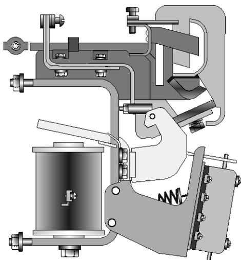
Выключение контактора осуществляется отключающей пружиной после снятия напряжения с катушки.
