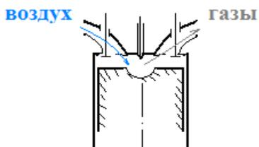
Четвертым тактом заканчивается рабочий цикл дизеля и в дальнейшем все такты последовательно повторяются.
