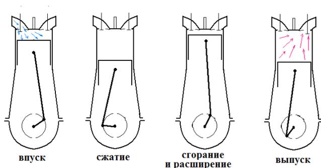
разбит на пять действительных процессов: **впуск, сжатие, горение, расширение, выпуск**. Все эти процессы проходят в четырехтактном
