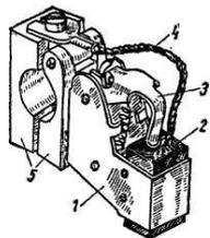
Щеточное устройство состоит: 1-обойма щеткодержателя; 2-щетка; 3- нажимная пружина; 4 -токоведущий кабель; 5- колодки
