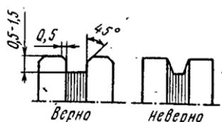
ра якоря и коллектора концы секций обмотки впаиваются в коллекторные пластины непосредственно или через специальные медные соединения – петушки 9. Коллектор жестко крепится на валу ротора рядом с сердечником якоря. Для исключения контакта между двумя коллекторными пластинами необходимо производить «продорожку» коллектора.
