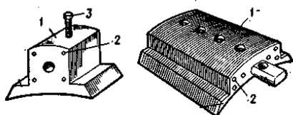
**Сердечник полюсов** набирается из листов электротехнической стали 1 толщиной  $0,5 \div 1,0$  мм, покрытых изоляционным лаком для уменьшения
