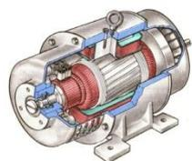
**Станина** – служит в качестве магнитопровода и одновременно является конструктивной основой, к которой крепятся главные и добавочные полюсы и подшипниковые щиты. Она представляет собой полый цилиндр, отлитый или сваренный из чугуна или стали.
