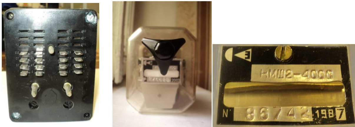
Рис.1. Монтажная, лицевая сторона и маркировка завода изготовителя реле НМШ2-4000
