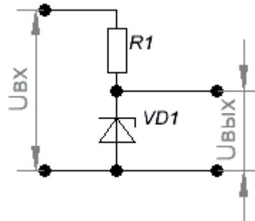
Для расчёта стабилизатора, как правило, используются только два параметра —  $U_{ст}$  (напряжение стабилизации),  $I_{ст}$  (ток стабилизации), при условии что ток нагрузки равен или меньше тока стабилизации.
