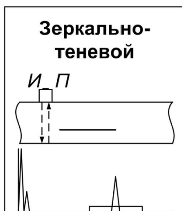
Рисунок 2 – Схема зеркально-теневого метода ультразвукового контроля
