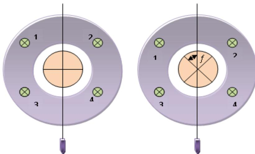
Рисунок Поверка положения сетки нитей зрительной трубы
