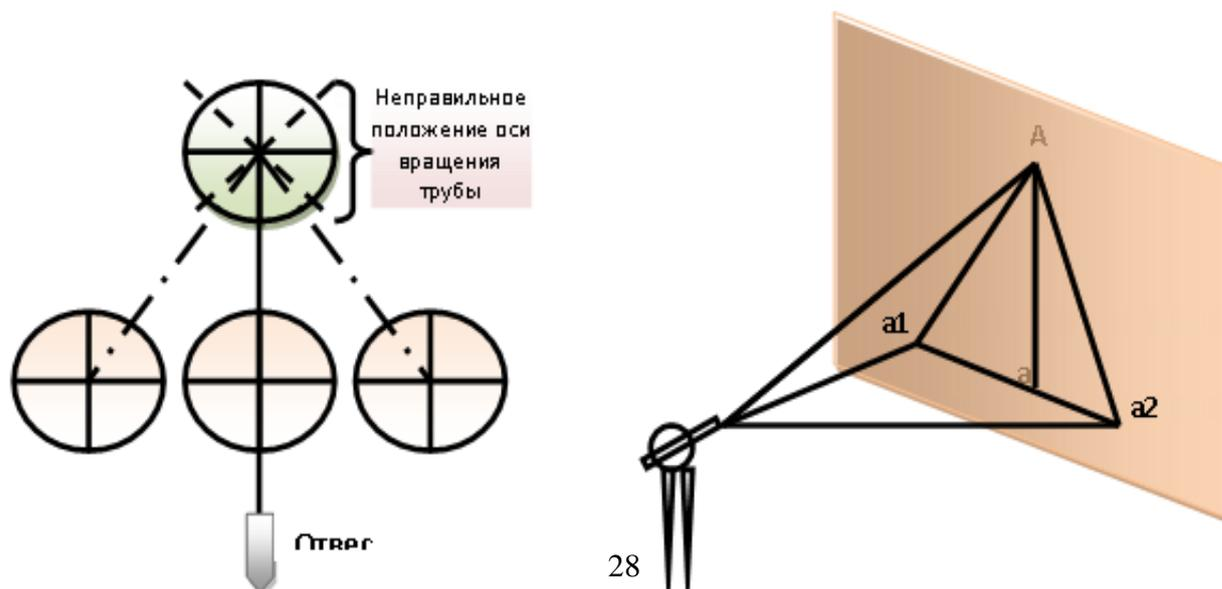
Схема поверки горизонтальной оси вращения трубы
