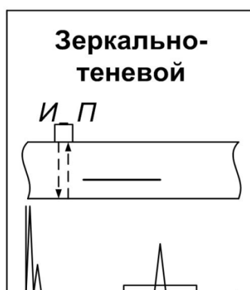
Рисунок 2 – Схема зеркально-теневого метода ультразвукового контроля
