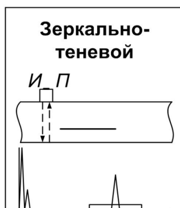
Рисунок 2 – Схема зеркально-теневого метода ультразвукового контроля
