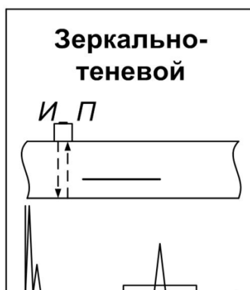
Рисунок 2 – Схема зеркально-теневого метода ультразвукового контроля
