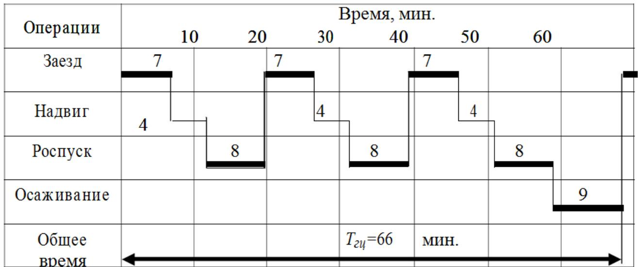
2. Составление графика работы сортировочной горки с двумя путями надвига и двумя горочными локомотивами при автоматизации процесса сортировки.
