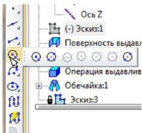
Рисунок 16 Вызов расширенной панели инструментов на примере окружности
