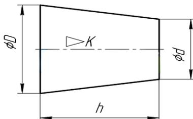
По ГОСТ 2.307—68 перед размерным числом, характеризующим конусность (рис.3), необходимо наносить условный знак конусности, который имеет вид равнобедренного треугольника с вершиной, направленной в сторону вершины конуса.
