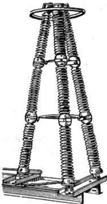
Рисунок 12 - Опорная конструкция на 330 кВ
