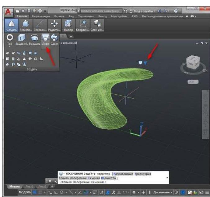
«Сдвиг» выдавливает геометрическую форму по заданной траектории. После выбора операции «Сдвиг», выделите форму, которая будет смещаться и нажмите «Enter», после этого выделите траекторию и еще раз нажмите «Enter».
