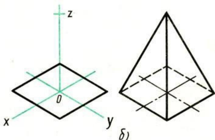
Рис. 21 . Правильная пирамида: а - комплексный чертеж; б - последовательность построения изометрической проекции
