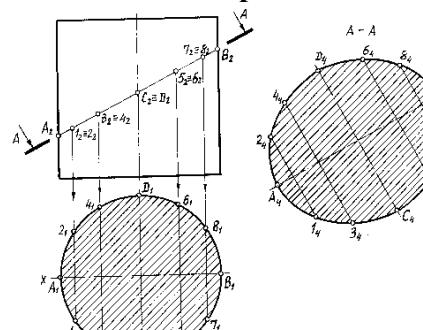
Если секущая плоскость будет проходить через образующие, то в сечении получим параллельные прямые, если через направляющие, то - окружность. Все остальные сечения цилиндра будут эллипсами. Построение
