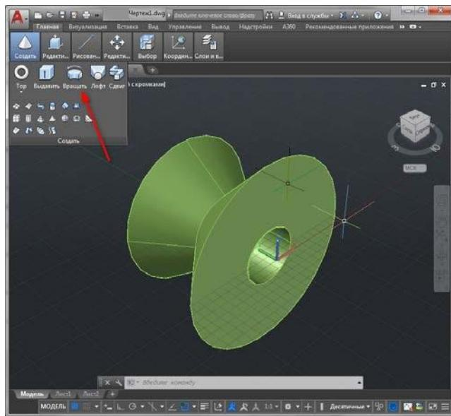
Инструмент «Лофт» создает форму на основе выбранных замкнутых сечений. После нажатия кнопки «Лофт» выбирайте поочередно нужные сечения и программа автоматически построит по ним объект. После построения пользователь может менять режимы построения тела (гладкий, по нормали и другие), нажав на стрелочку возле объекта.
