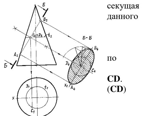
Как известно, любое сечение шара плоскостью является кругом. В зависимости от положения секущей плоскости, окружность, ограничивающая фигуру сечения, может спроектироваться в: - окружность, если секущая плоскость параллельна плоскости проекций; - отрезок прямой, если секущая плоскость перпендикулярна плоскости
