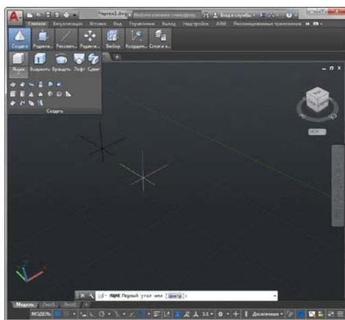
Панель создания геометрических тел
