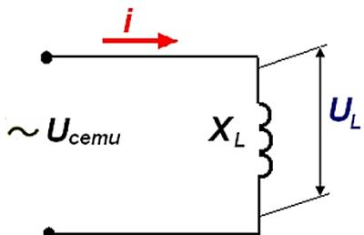
*Ток в цепи с индуктивностью отстает от напряжения этой цепи  $1/4$  периода, или  $\angle \varphi = 90^\circ$*
