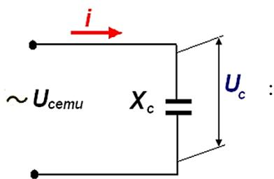
*Ток в цепи с емкостью в своих изменениях опережает по фазе напряжение конденсатора на  $1/4$  периода, или  $\angle \varphi = 90^\circ$*
