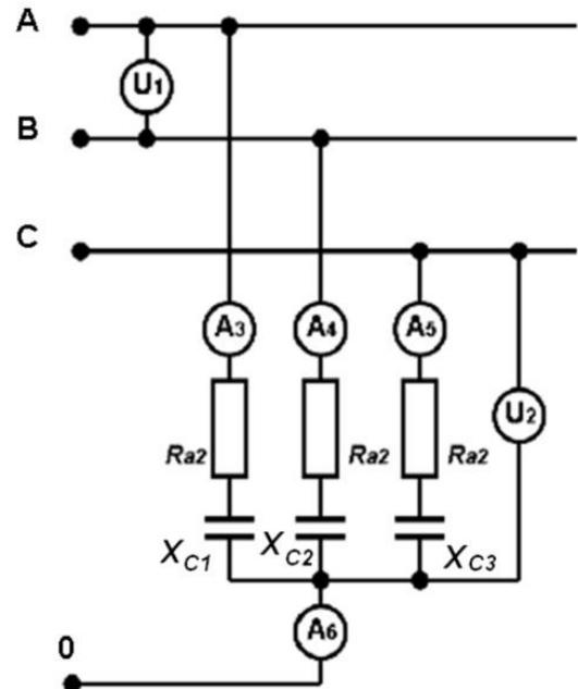
При соединении генератора и нагрузки «звездой» линейный ток равен фазному току:
