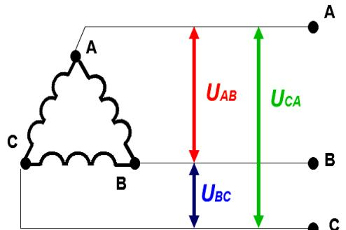
Схема соединения обмоток трехфазного генератора треугольником
