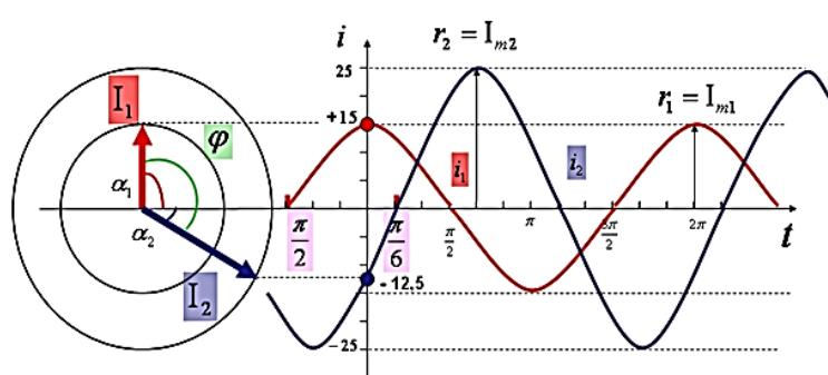
5. Определяем угол сдвига фаз между токами  $i_1$  и  $i_2$
