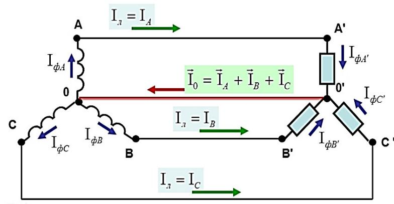
Трехфазная четырехпроводная система переменного тока
