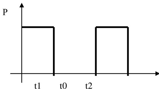
На щитке такого эл. двигателя указывается время работы при номинальной мощности: 15, 30, 60, 90 минут и символ S2.
