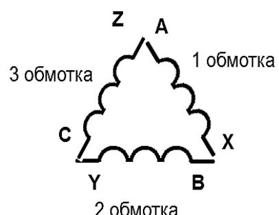
При таком соединении обмоток *фазные напряжения равны линейным*:
