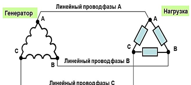
Схема включения генератора и нагрузки «треугольником»
