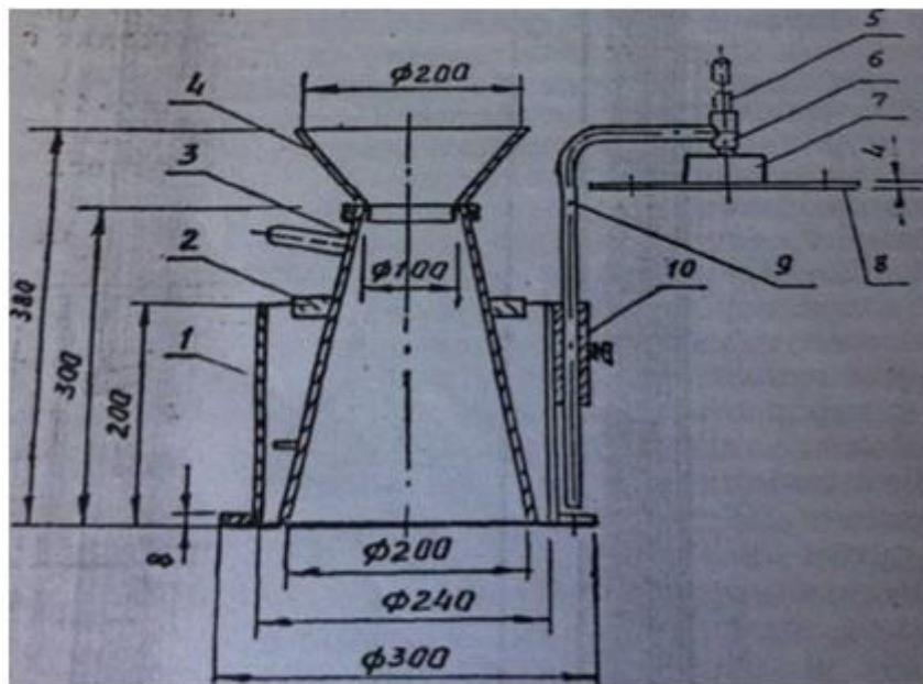
Рис 28 Прибор для определения жесткости бетонной смеси:
