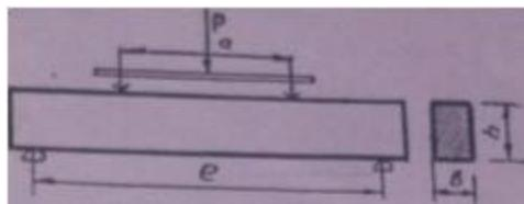
Рисунок 7. Схема испытания образца на изгиб при действия двух нагрузок
