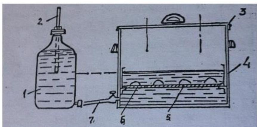
Рис. 17. Бачок для испытания лепешек кипячением с регулятором уровня воды:
