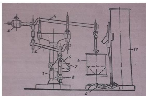
Рис.14. Рычажной прибор Михаэлиса:
