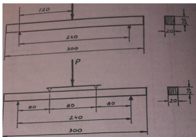
Рис. 8. Схема испытания образцов древесины на изгиб
