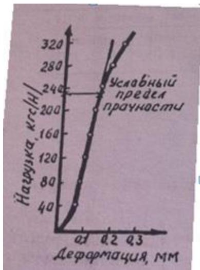
Рисунок10. График деформации древесины поперёк волокон
