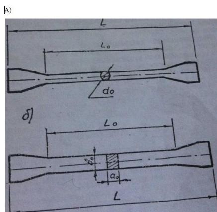
Рисунок 30 Образцы стали для испытания:
