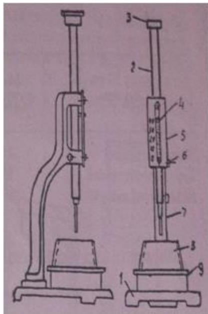
Рисунок 12. Прибор Вика: 1—металлическая станина; 2—подвижный стержень; 3—площадка для дополнительного груза; 4—указатель; 5—шкала; 6—зажимной винт; 7—пестик или стальная игла; 8—кольцо; 9—стеклянная пластина.
