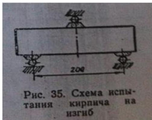
Опоры должны иметь закругления радиусом 10–15 мм. В целях более плотного и правильного прилегания образца к опорам на кирпич укладывают из цементного раствора три полоски толщиной 3 мм и шириной 20–30 мм, или прокладки, две полоски в местах опирания на нижние опоры, одну под опору передающую нагрузку. Подготовленные образцы выдерживают в лаборатории в течение трех суток при температуре  $20 \pm 5^{\circ}\text{C}$  до затвердения раствора.
