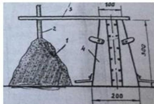
Рис 27. Определение подвижности
