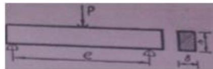
Рисунок 6. Схема Испытания образца на изгиб при действии одной нагрузки, приложенной по середине пролета
