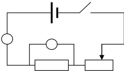
1. Измерить ЭДС источника Эл энергии, замкнув его на вольтметр
