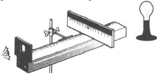
Если лампу поставить за непрозрачным экраном против узкой щели, то при рассматривании щели через дифракционную решетку мы увидим симметрично расположенные по обе стороны от щели две разноцветные полосы-дифракционные спектры. Роль линзы, собирающей в одну точку параллельный пучок лучей, идущих под углом  $\alpha$  от дифракционной решетки, выполняет оптическая система
