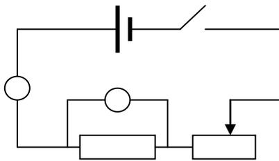
1. Составить цепь из последовательно соединенного источника (батареи элементов), амперметра, ключа и магазина сопротивлений и проволочного резистора.
