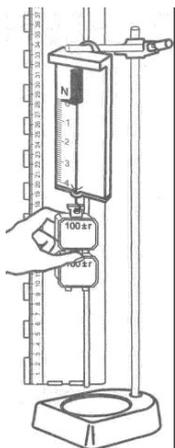
1. Последовательно добавляйте гирьки массой 100 г и каждый раз обозначайте новое положение пружины.
