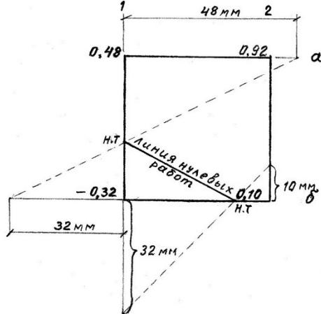
Рис.7. Графическое определение положения нулевых точек
