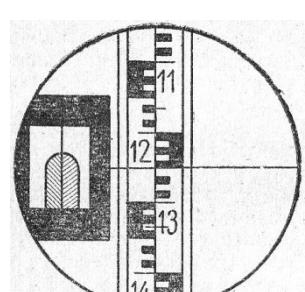
Поле зрения зорительной трубы в рабочем положении нивелира при наведении на красную сторону рейки.
