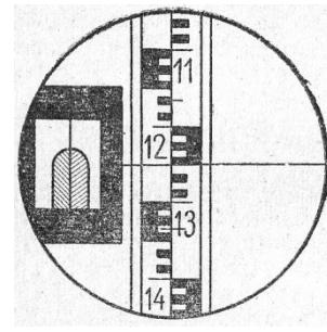
Поле зрения зрительной трубы в рабочем положении нивелира при наведении на чёрную сторону рейки.
