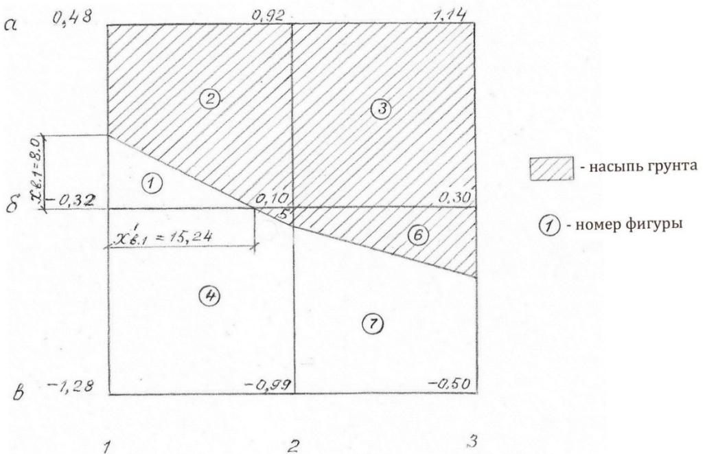
В каждом контуре образовались геометрические фигуры в виде треугольников, трапеций, квадрата и пятигранныков. Перед вычислением объёмов работ их нумеруют.
