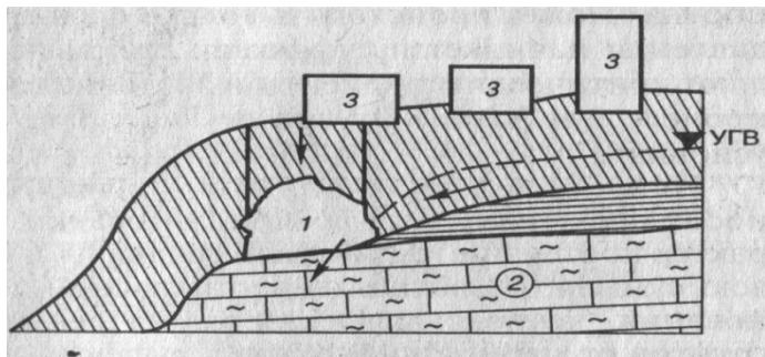
Рис. 124. Суффозионная полость (1) в лессовых породах, залегающих на склоне рельефа, сложенном известняками-ракушечниками (2); 3 — здания
