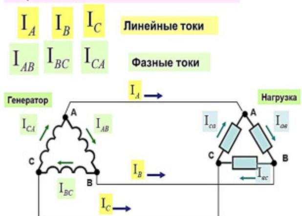
Линейные токи равны геометрической разности фазных токов.
