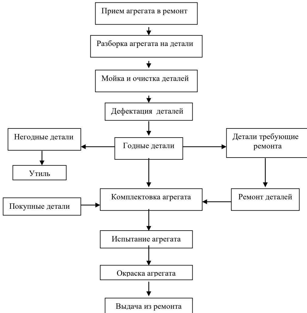
Рис. 1.1. Схема технологического процесса на агрегатном участке
