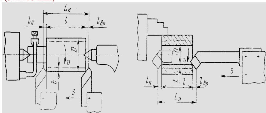
Рис. 2.7. Элементы, составляющие путь резца (детали) при обтачивании
