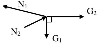
Осталось выяснить, растянуты или сжаты стержни 1 и 2. Для этого перенесем силы  $N_1$  и  $N_2$  из многоугольника сил к соответствующим стержням, в результате чего найдем, что стержень 1 растянут, т.к. направлен от узла, а стержень 2 сжат (направлен к узлу).
