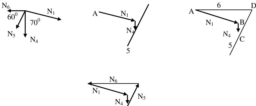
Выясним, растянуты стержни или сжаты. Для этого перенесем силы  $N_5$  и  $N_6$  из многоугольника сил к соответствующим стержням, в результате чего установим, что стержень 5 сжат, а стержень 6 растянут.
