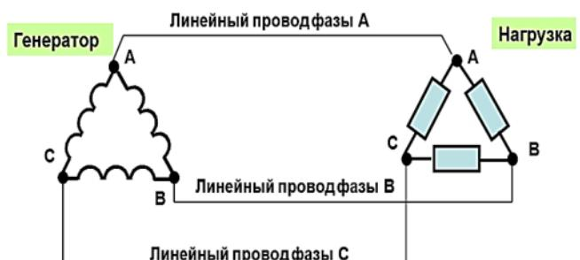
Схема включения генератора и нагрузки «треугольником»
