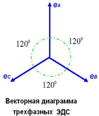
Такую же диаграмму имеют фазные напряжения генератора  $U_A, U_B, U_c$ .
