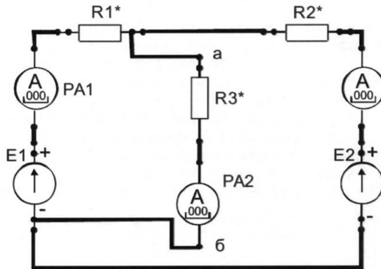
Рис 3.1 Электрическая цепь постоянного тока с двумя источниками электропитания
