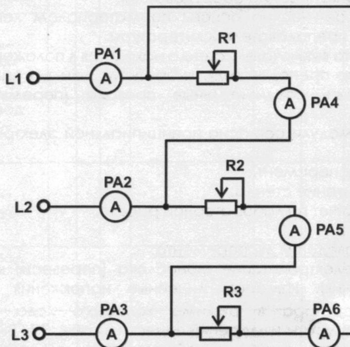
Рис. 3.1 Исследование трехфазной электрической цепи при соединении потребителей по схеме «треугольник».
