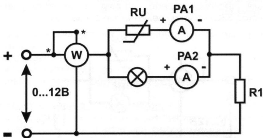
Рис. 3.3 Исследование нелинейной цепи постоянного тока
