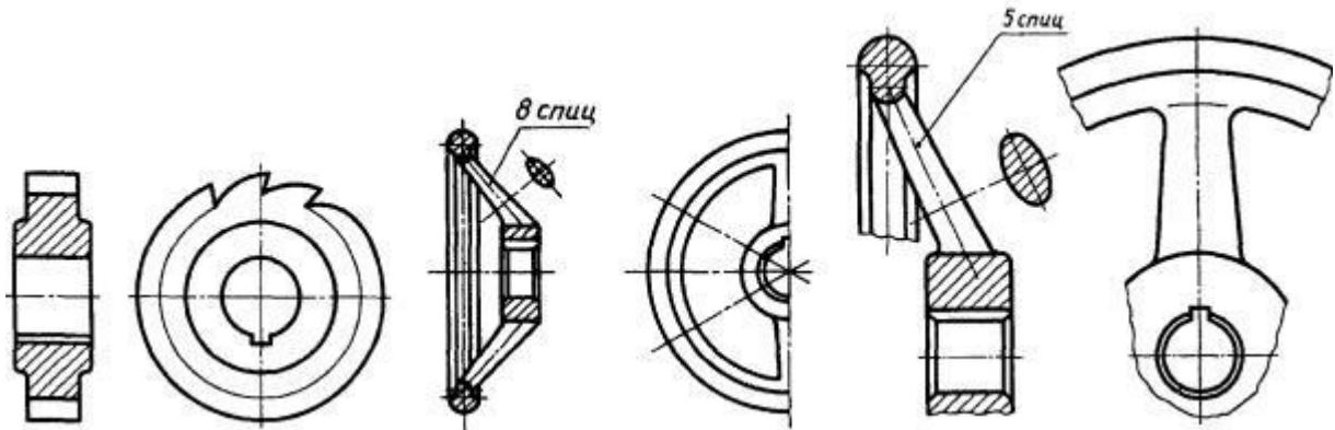
На видах и разрезах допускается упрощенно изображать проекции линий пересечения поверхностей, если не требуется точного их построения. Например, вместо лекальных кривых проводят дуги окружности и прямые линии.
