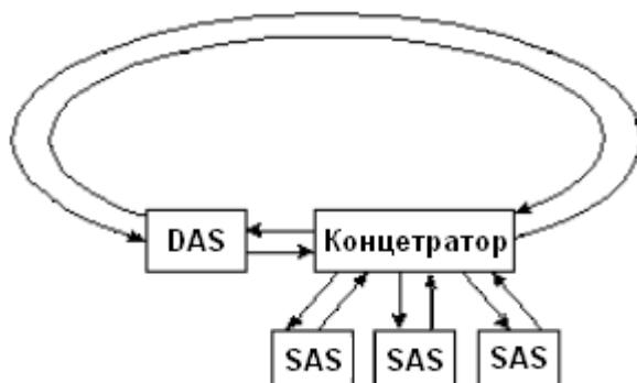
В сети FDDI нет выделенного активного монитора - все станции и концентраторы равноправны, и при обнаружении отклонений от нормы они
