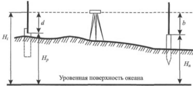
Рис. 3. Схема выноса в натуру проектной высоты
