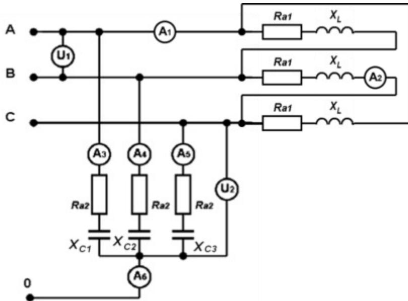
1. Расчет трехфазных электрических цепей, соединенных «треугольником»:
