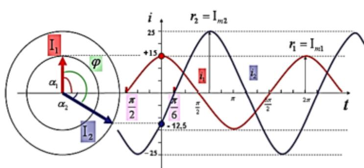
5. Определяем угол сдвига фаз между токами  $i_1$  и  $i_2$
