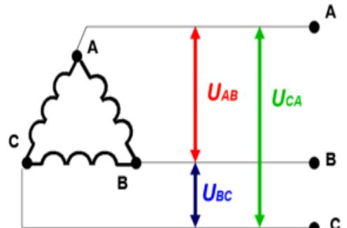
Схема соединения обмоток трехфазного генератора треугольником
