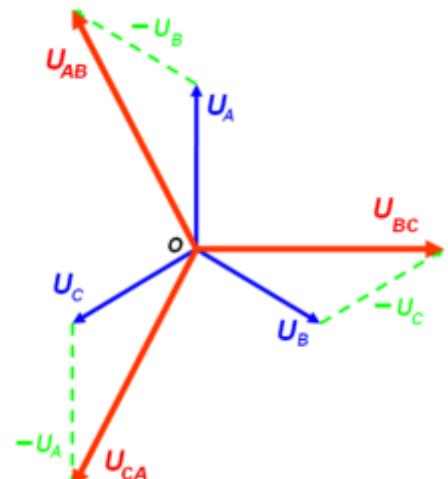
Из векторной диаграммы видно, что вектор линейного напряжения при соединении обмоток генератора «звездой» больше вектора фазного напряжения в  $\sqrt{3}$ :
