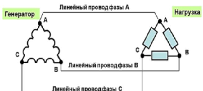
Схема включения генератора и нагрузки «треугольником»
