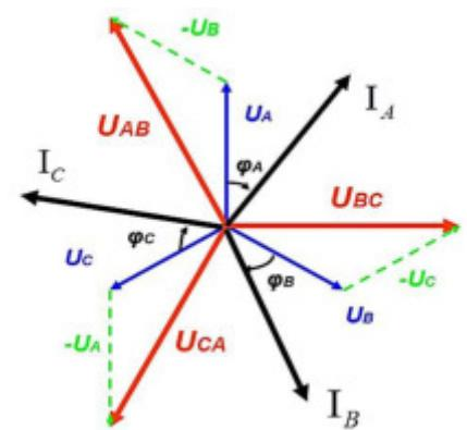
Векторная диаграмма линейных и фазных напряжений, линейных токов для соединения «звездой»
