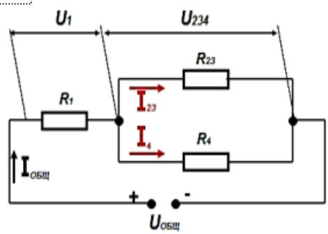
Дано:  $R_1$ ,  $R_2$ ,  $R_3$ ,  $R_4$ ,  $U_{общ}$ ,  $I_{общ}$ ,  $U_1$ ,  $U_{234}$ ,  $I_{23}$ ,  $I_4$
