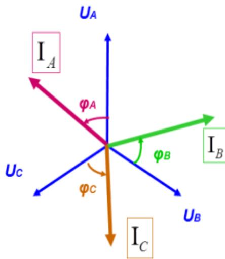
Ток в нулевом проводе равен геометрической сумме трех фазных токов:
