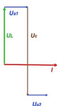
6. После геометрического сложения всех четырех векторов напряжений определяем полное напряжение схемы:
