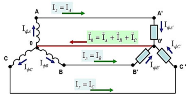
Трехфазная четырехпроводная система переменного тока
