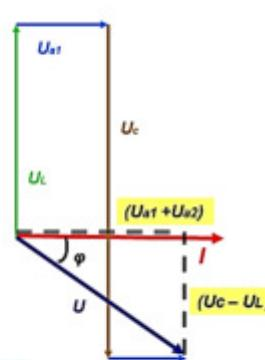
ОПРЕДЕЛЯЕМ активную мощность электрической цепи:
