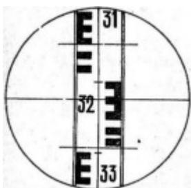
Поле зрения зрительной трубы в рабочем положении нивелира при наведении на красную сторону рейки.
