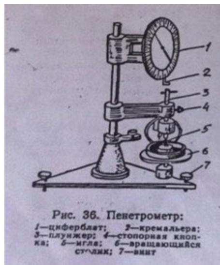
Рис. 36. Пенетрометр:
