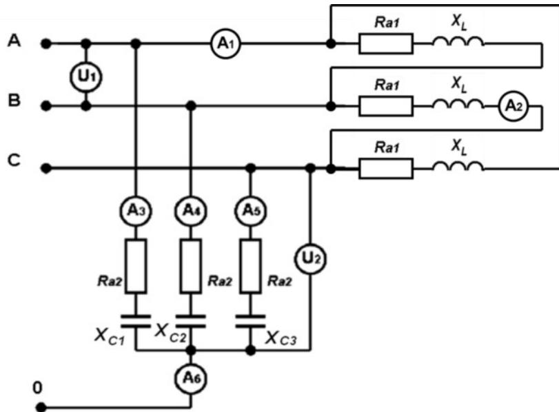
1. Расчет трехфазных электрических цепей, соединенных «треугольником»:
