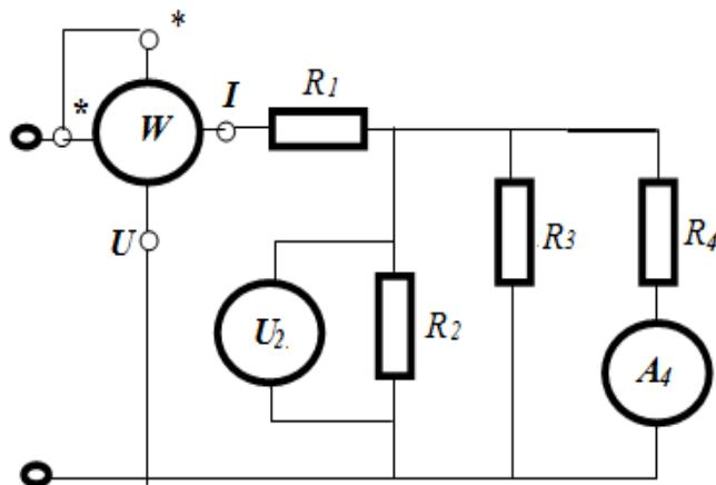
Чтобы правильно выбрать амперметр для измерения тока  $I_4 = 1,3 \text{ A}$ , пользуемся таблицей № 1 по правилу  $I_{\text{ном}} \geq I_4$ . Лучше всех подходит амперметр с  $I_{\text{ном}} = 2 \text{ A}$  и классом точности  $\gamma = 1,0 \%$  (в таблице амперметр стоит №4)
