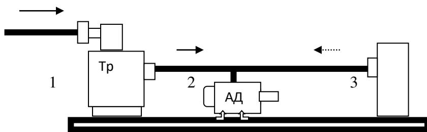
Рис. 2. Схема применения правильной компенсации реактивной мощности электродвигателя. 1. трансформатор; 2. электродвигатель; 3. конденсатор.
