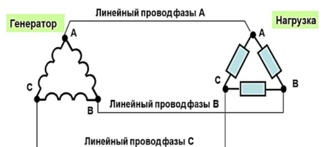
Схема включения генератора и нагрузки «треугольником»
