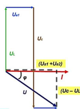
ОПРЕДЕЛЯЕМ активную мощность электрической цепи:
