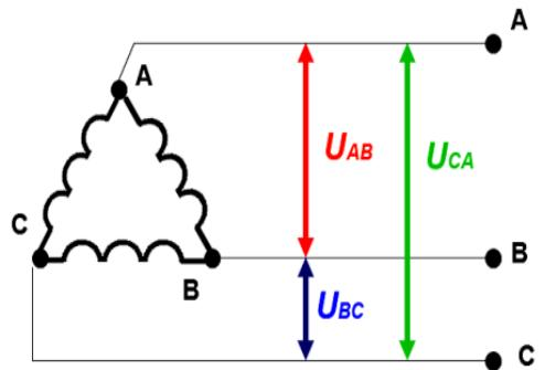
Схема соединения обмоток
