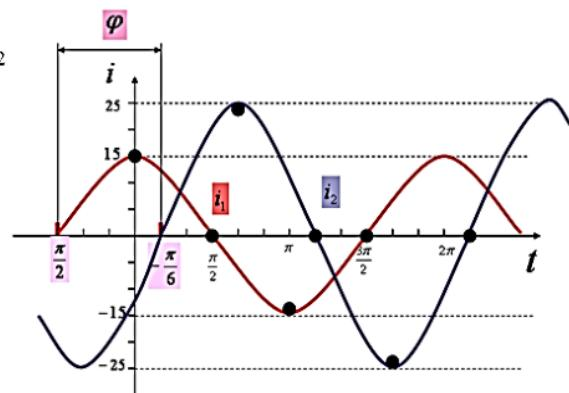
Строим по этим значениям вспомогательные окружности. Переносим значения токов в соответствии с их начальными фазами  $\alpha_1 = \frac{\pi}{2}$   $\alpha_2 = -\frac{\pi}{6}$  на эти окружности. Строим вектора токов.
