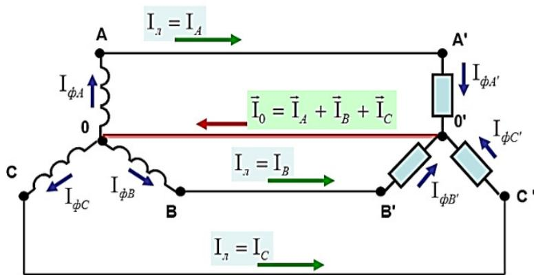
Трехфазная четырехпроводная система переменного тока
