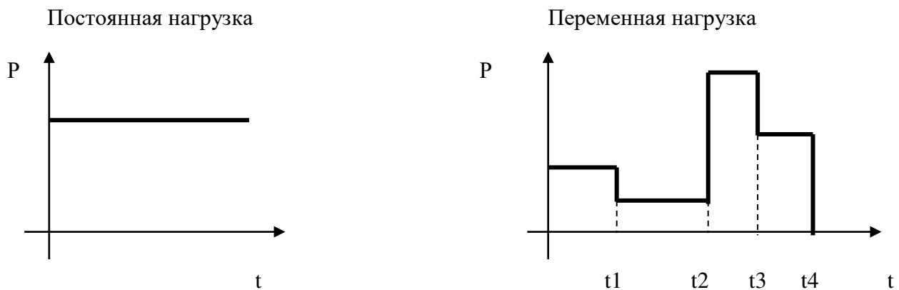
На щитке эл.двигателя, предназначенного для продолжительного режима работы, номинальный режим обозначается сокращенным словом "Длит." или S1.
