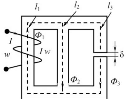
Рис. 3 — Разветвленная магнитная цепь
