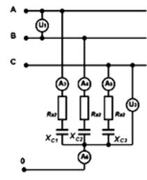
Определить: показания всех приборов, включенных в схему и построить векторные диаграммы нагрузок если  $U_1 = 220 \text{ В}$
