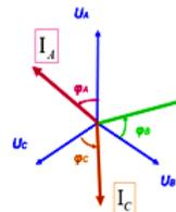
Ток в нулевом проводе равен геометрической сумме трех фазных токов:
