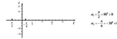
5. Определим угол сдвига фаз между токами  $i_1$  и  $i_2$
