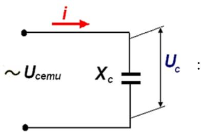
*Ток в цепи с емкостью в своих изменениях опережает по фазе напряжение конденсатора на  $1/4$  периода, или  $\angle \varphi = 90^\circ$*
