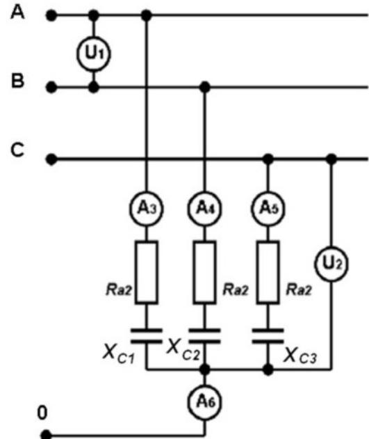
При соединении генератора и нагрузки «звездой» линейный ток равен фазному току:
