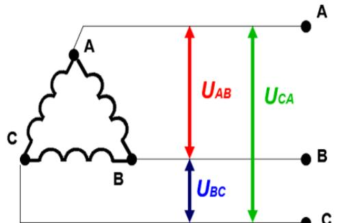
Схема соединения обмоток трехфазного генератора треугольником
