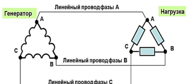
Схема включения генератора и нагрузки «треугольником»
