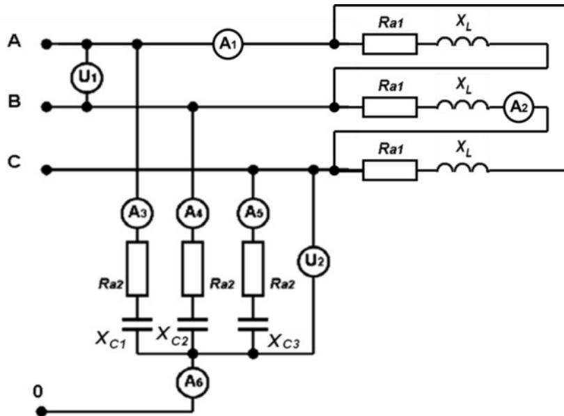
1. Расчет трехфазных электрических цепей, соединенных «треугольником»:
