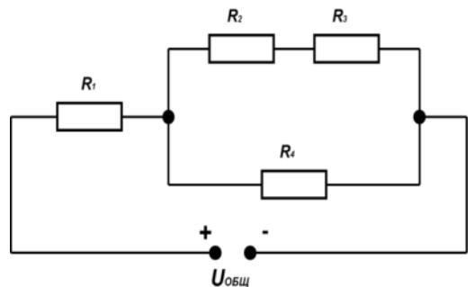
Преобразуем схему, разбив ее на части. В этих частях должны присутствовать простейшие, чисто последовательные или чисто параллельные соединения.
