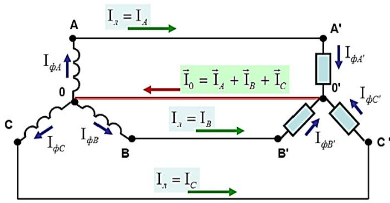
Трехфазная четырехпроводная система переменного тока
