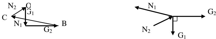
Осталось выяснить, растянуты или сжаты стержни 1 и 2. Для этого перенесем силы  $N_1$  и  $N_2$  из многоугольника сил к соответствующим стержням, в результате чего найдем, что стержень 1 растянут, т.к. направлен от узла, а стержень 2 сжат (направлен к узлу).
