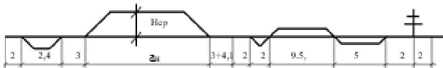
Рисунок 1- Поперечный профиль земляного полотна на участках где насыпь отсыпается из выемки или карьера
