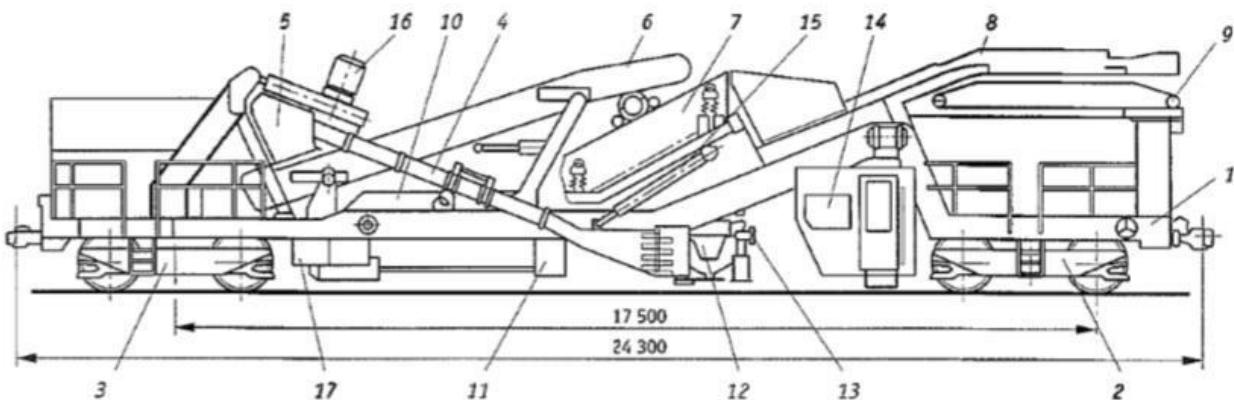
Рис.3.Общий вид щебнеочистительной машины СЧ-600
