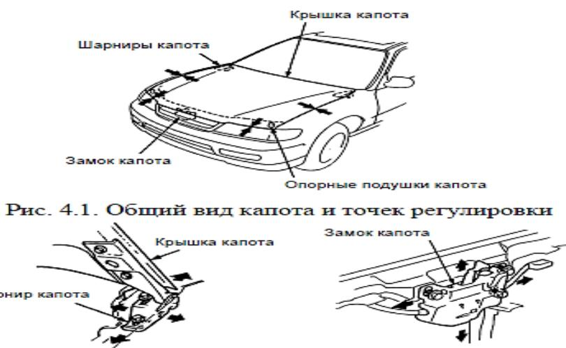
Рис. 5.2. Регулировочные движения шарнира и замка капота
