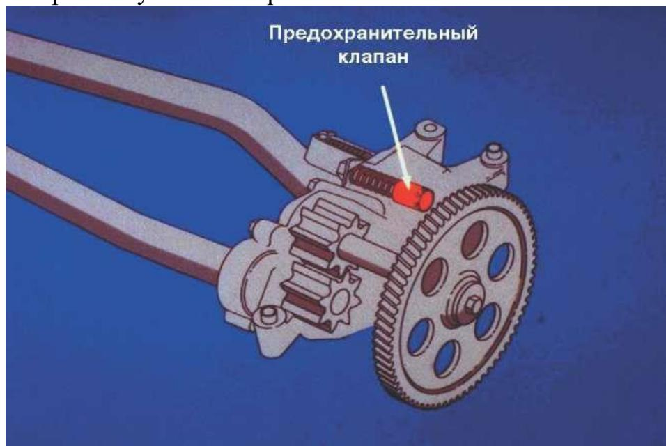
**Рис. 8. Предохранительный клапан масляного насоса**
