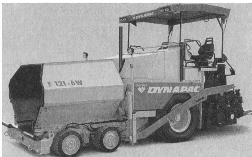
Рис. 8.11. Колесный асфальтоукладчик
