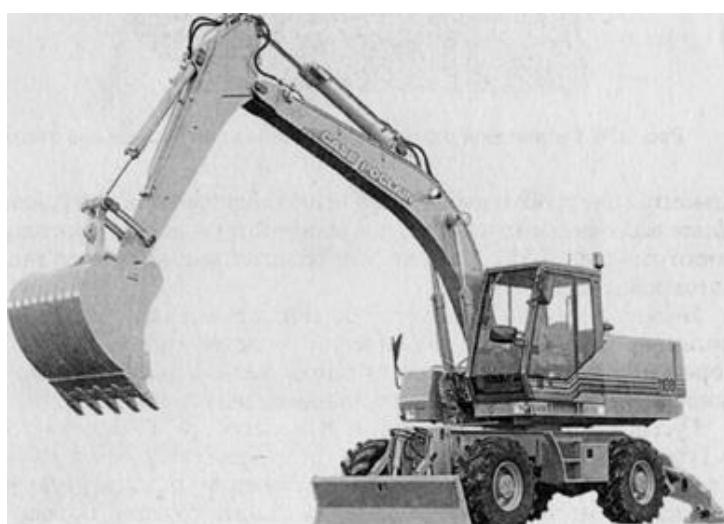
Рис. 5.55. Пневмоколесный одноковшовый полноповоротный экскаватор
