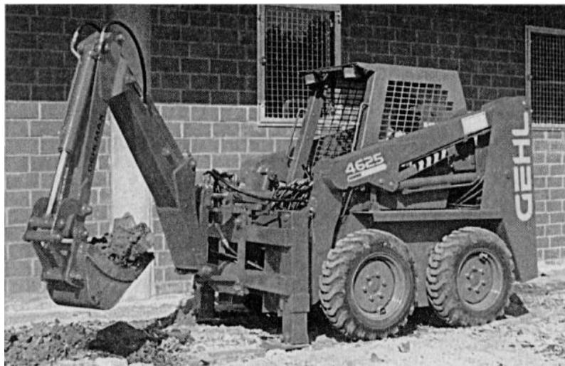
Рис. 5.58. Сменное неполноповоротное экскаваторное оборудование на мини-погрузчике
