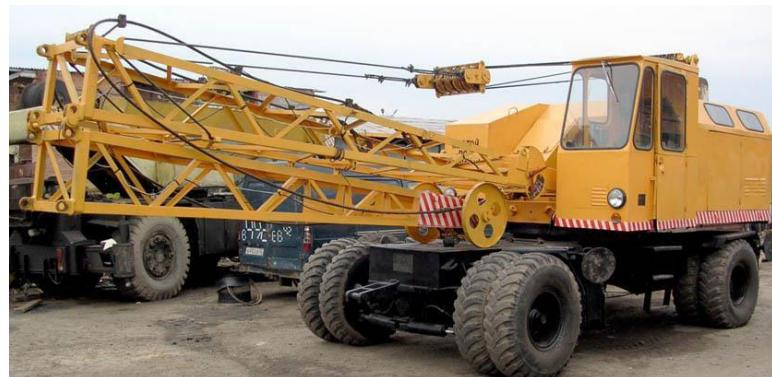
Рис.2.17. Пневмоколесный кран КС-4361А
