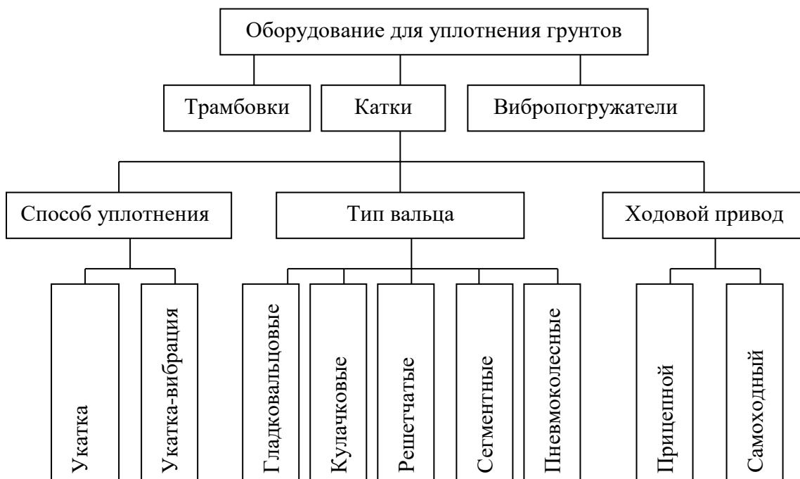
Рис. 2.38. Классификация оборудования для уплотнения грунтов
