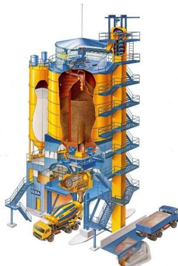
Рисунок1. Бетоносмесительная установка башенного типа
