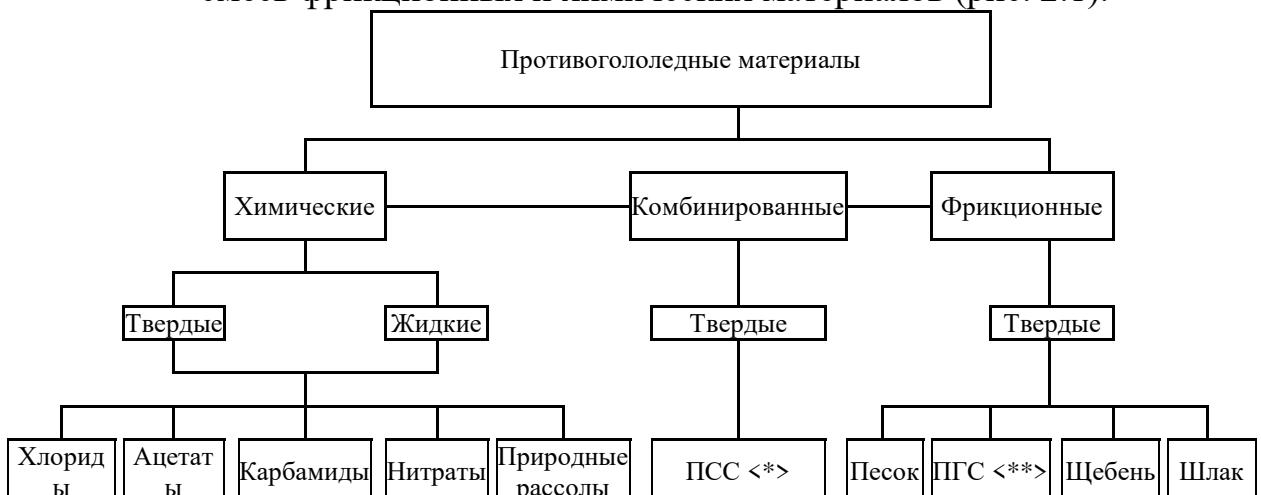
Рисунок 1- Классификация противогололедных материалов
