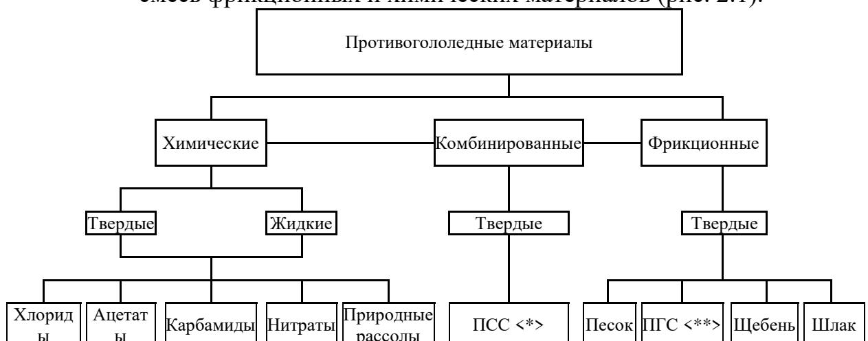
Рисунок 1- Классификация противогололедных материалов
