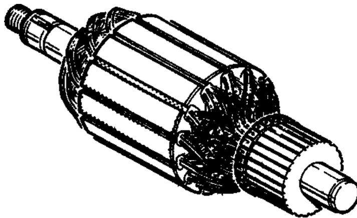
Рис. 3. Типичный якорь с коллектором двигателя постоянного тока
