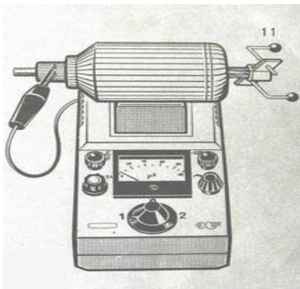
Рис. 27. Проверка ротора на наличие межвиткового замыкания.
