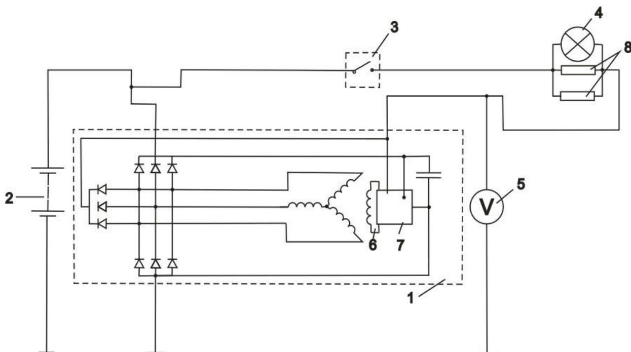
Рис. 11. Схема генераторной установки с генератором 37.3701 (ВАЗ-2108): 1 – генератор, 2 – аккумуляторная батарея, 3 – замок зажигания, 4 – контрольная лампа заряда аккумуляторной батареи, 5 – вольтметр, 6 – обмотка возбуждения, 7 – регулятор напряжения, 8 – дополнительные резисторы
