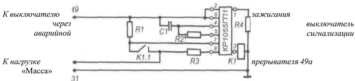
Рисунок 5. Реле-прерыватель 493.3747 указателя поворота на микросхеме КР1055 ГП1
