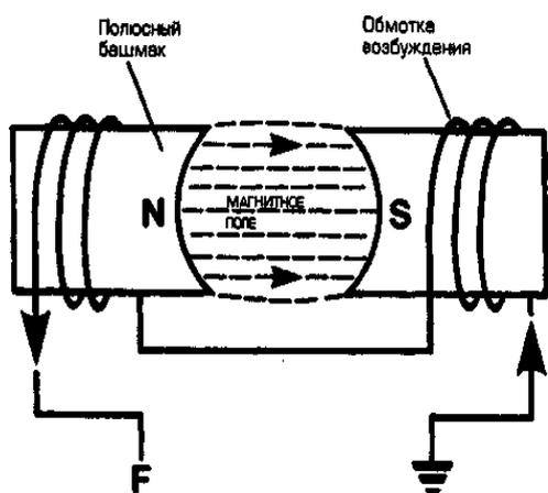
Рис. 5. Схема возбуждения полюсов магнитного потока
