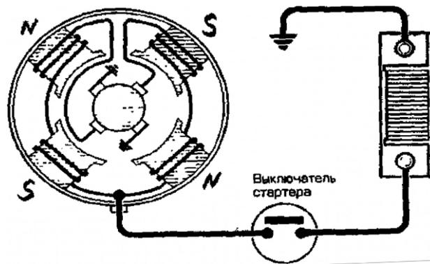
Рис. 9. Последовательное соединение обмоток возбуждения
