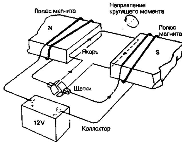
Рис. 7. Электродвигатель постоянного тока с последовательным возбуждением
