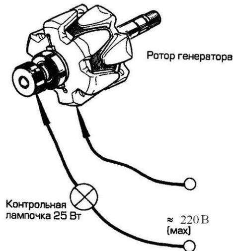
Рис 17. Проверка сопротивления изоляции обмотки ротора.
