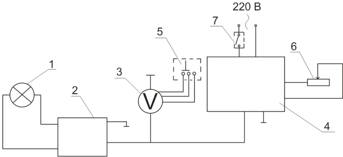
Рис. 11. Электрическая схема лабораторной установки для испытания регуляторов напряжения: 1 – контрольная лампа; 2 – испытуемый регулятор напряжения; 3 – вольтметр; 4 – блок питания; 5 – переключатель режима вольтметра 15 или 60 В; 6 – регулятор напряжения; 7 – выключатель питания блока.
