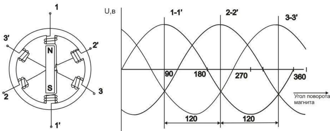
Рис 4. Трехфазный генератор и напряжение на его выводах
