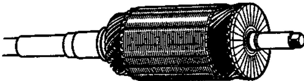
Рис.4. Типичная конструкция якоря электродвигателя с торцевым коллектором
