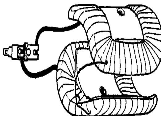
Рис. 6. Устройство статора
