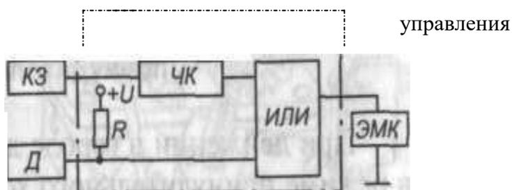
рисунок 1. Функциональная схема ЭПХХ
