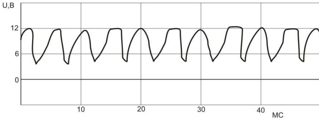
Рис.13 Осциллограмма напряжения при обрыве в одной из обмоток статора.
