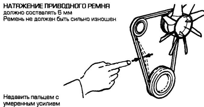
Рис 1. Проверка натяжного ремня.
