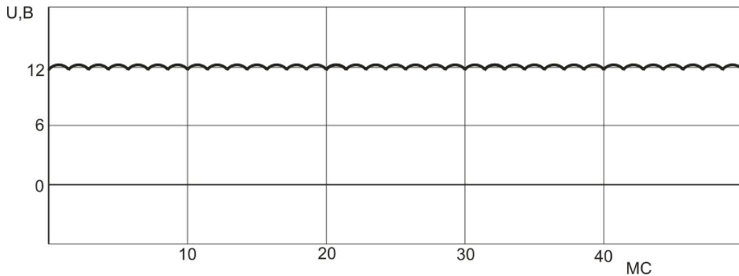
Рис.12. Осциллограмма напряжения исправного генератора.
