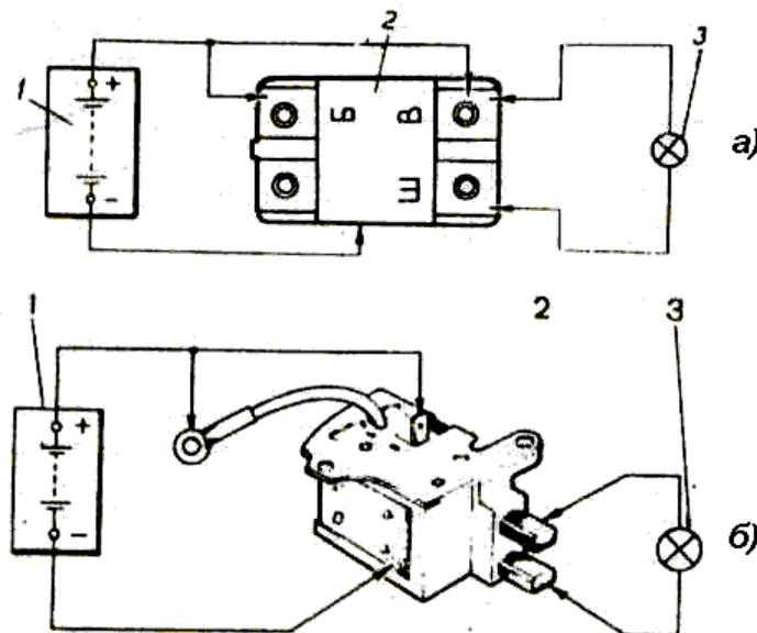
Рис 21. Схема проверки регулятора напряжения: а – генератора Г-222; б – генератора 37.3701; 1 – аккумуляторная батарея; 2 – регулятор напряжения; 3 – контрольная лампа.
