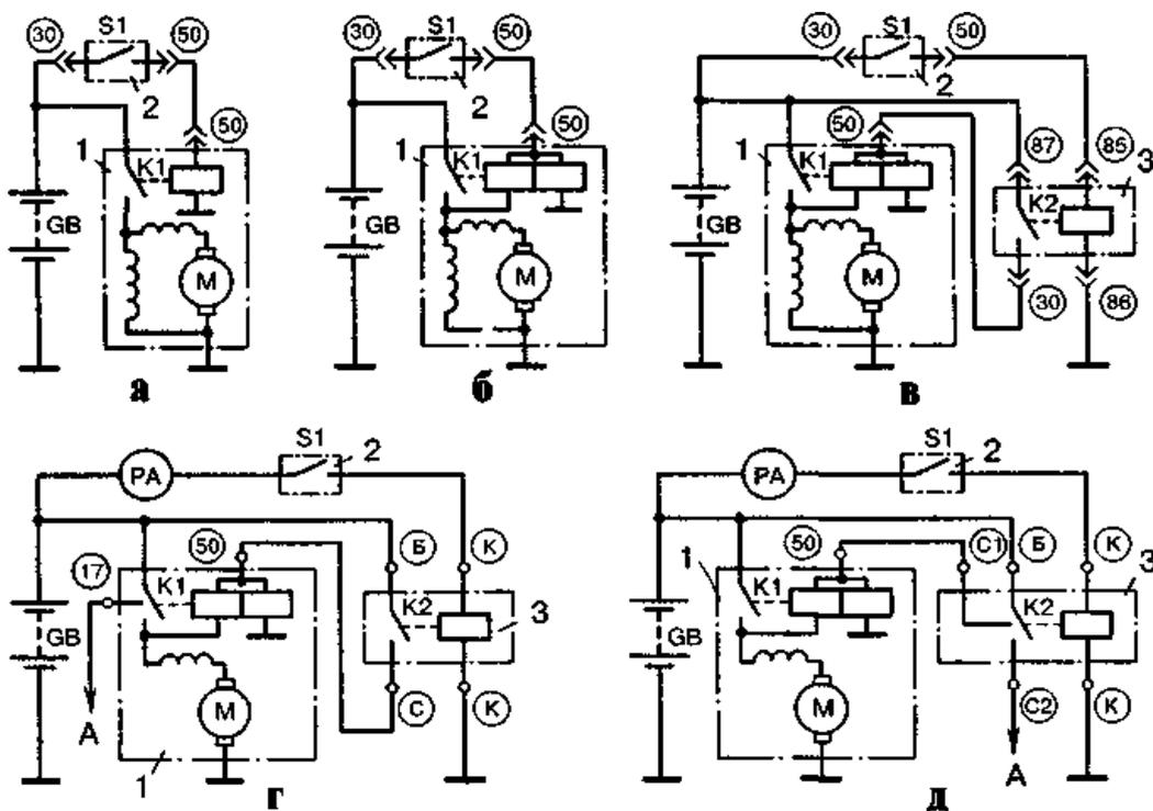
Рис.14. Схема управления электростартерами: а – СТ221 с однообмоточным реле; б – СТ221 с двухобмоточным реле; 29.3708 на первых моделях ВАЗ-2108; в – 29.3708 на автомобилях ВАЗ-
