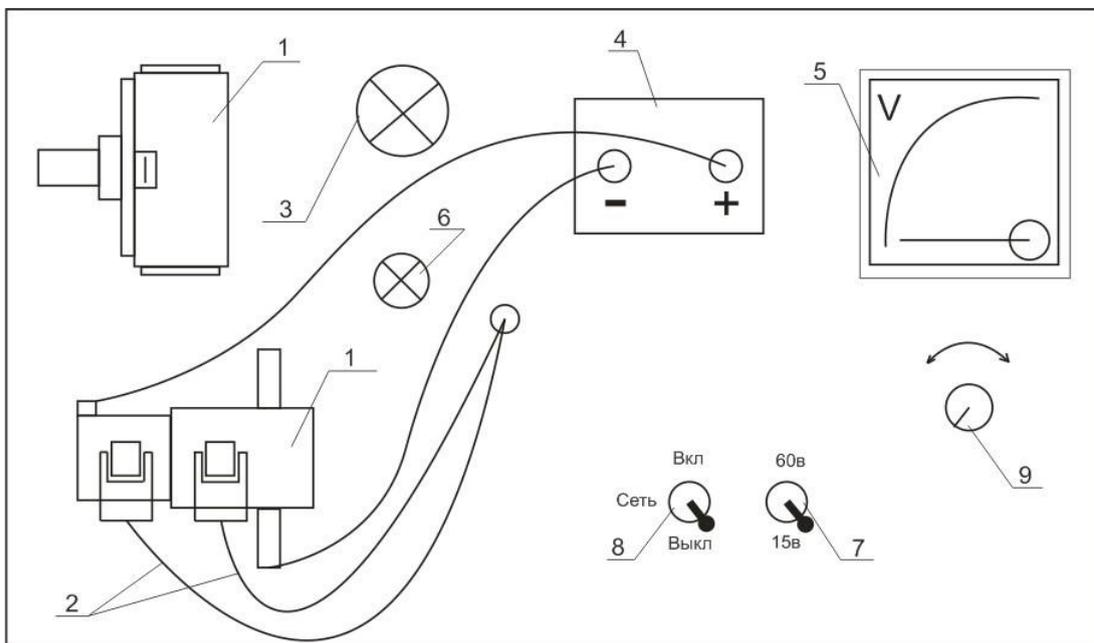
Рис. 8. Схема лабораторной установки для испытания регуляторов напряжения: 1 – регуляторы напряжения; 2 – выводы контрольной лампы; 3 – контрольная лампа включения питания; 4 – контактная площадка блока питания; 5 – вольтметр; 6 – контрольная лампа; 7 – переключатель режима вольтметра; 8 – выключатель питания; 9 – регулятор напряжения.
