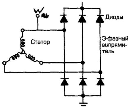
Рис. 12. Подключение тахометра к генератору
