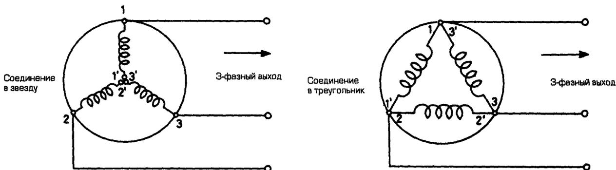
Рис 5. Соединение катушек в звезду и треугольник
