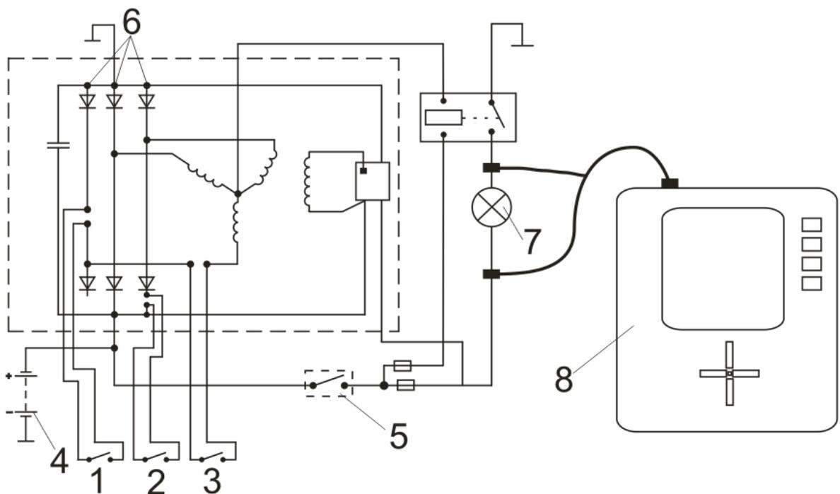
Рис 10 Электрическая схема лабораторной установки для испытания генераторов: 1 – выключатель имитации обрыва положительного диода; 2 – выключатель имитации отрицательного диода; 3 – выключатель имитации обрыва обмотки; 4 – аккумуляторная батарея; 5 – выключатель обмотки возбуждения, 6 – выпрямительные диоды, 7 – нагрузочная лампа, 8 - осциллограф DMO 510.
