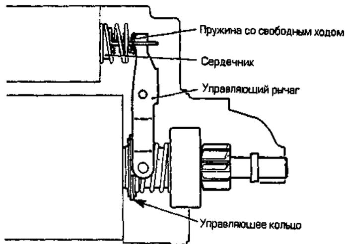
Рис. 12. Рычажный механизм стартера
