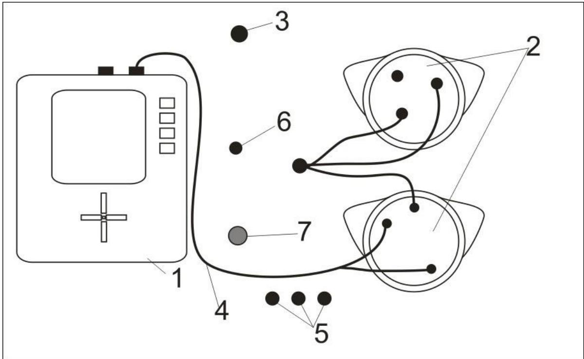
Рис 6. Схема лабораторной установки для испытания генераторов:1 – осциллограф; 2 – генераторы; 3 – лампа индикатор включения питания генератора; 4 – кабель второго канала осциллографа; 5 – выключатели имитаций неисправностей; 6 – лампа нагрузки; 7 – выключатель питания; 8 – мультиметр.
