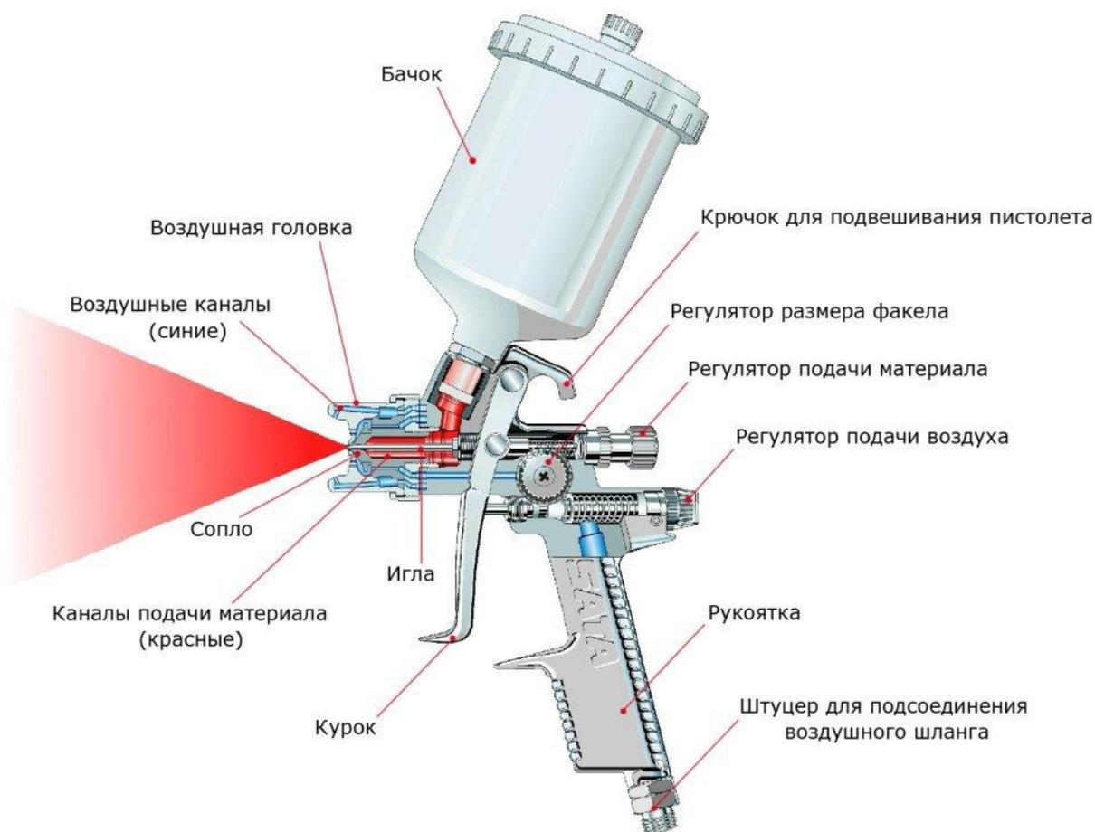
Рис. 9.1. Устройство окрасочного пистолета (краскопульт):
