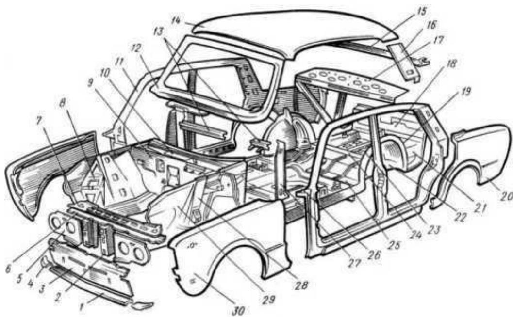
Рис. 1.3. Элементы основы кузова
