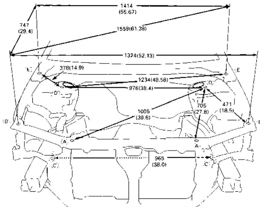
Рис. 3.2. Размеры передней части кузова
