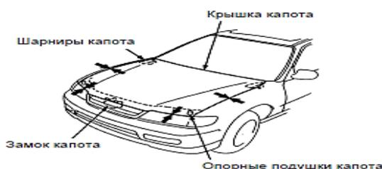
Рис. 4.1. Общий вид капота и точек регулировки
