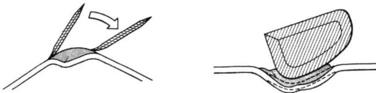
Рис. 7.3. Нанесение шпатлевок на изогнутую поверхность
