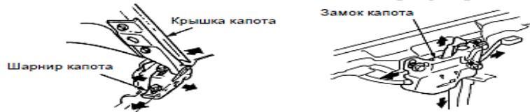
Рис. 5.1. Общий вид капота и точек регулировки
