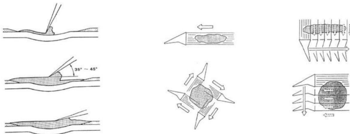
Рис. 7.1. Движения шпателя при укладке шпатлевки
