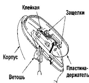
Рис. 4.1. Снятие пластины
