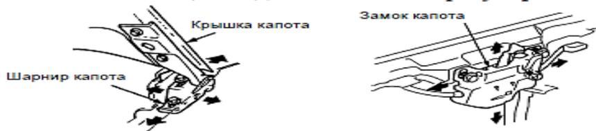
Рис. 5.2. Регулировочные движения шарнира и замка капота
