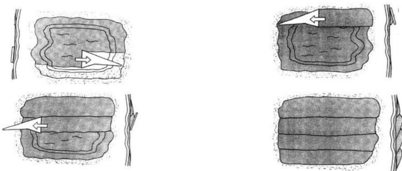
Рис. 7.2. Нанесение шпатлевок на вертикальную
