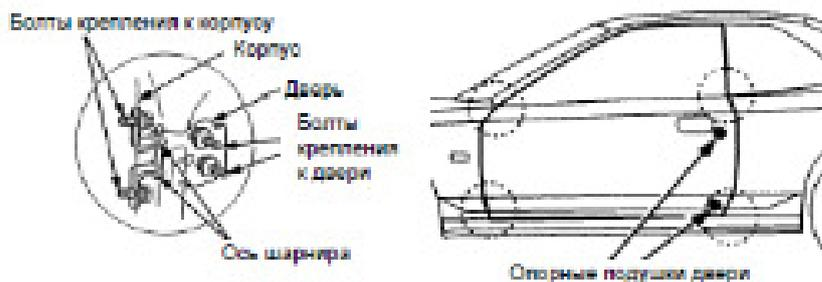
Рис. 5.4. Крепление шарнира Рис. 5.5. Опорные подушки
