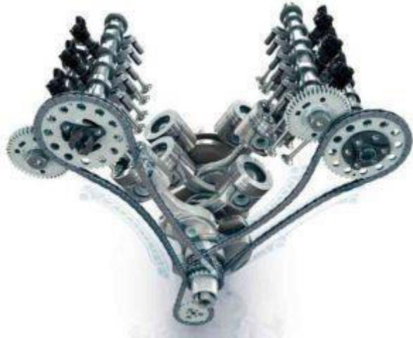
Конструктивно в образный двигатель значительно сложнее стандартного рядного мотора. Ведь они оснащаются двумя головками блока цилиндров (ГБЦ) и имеют более сложные механизмы газораспределения (ГРМ) и впрыска топлива.
