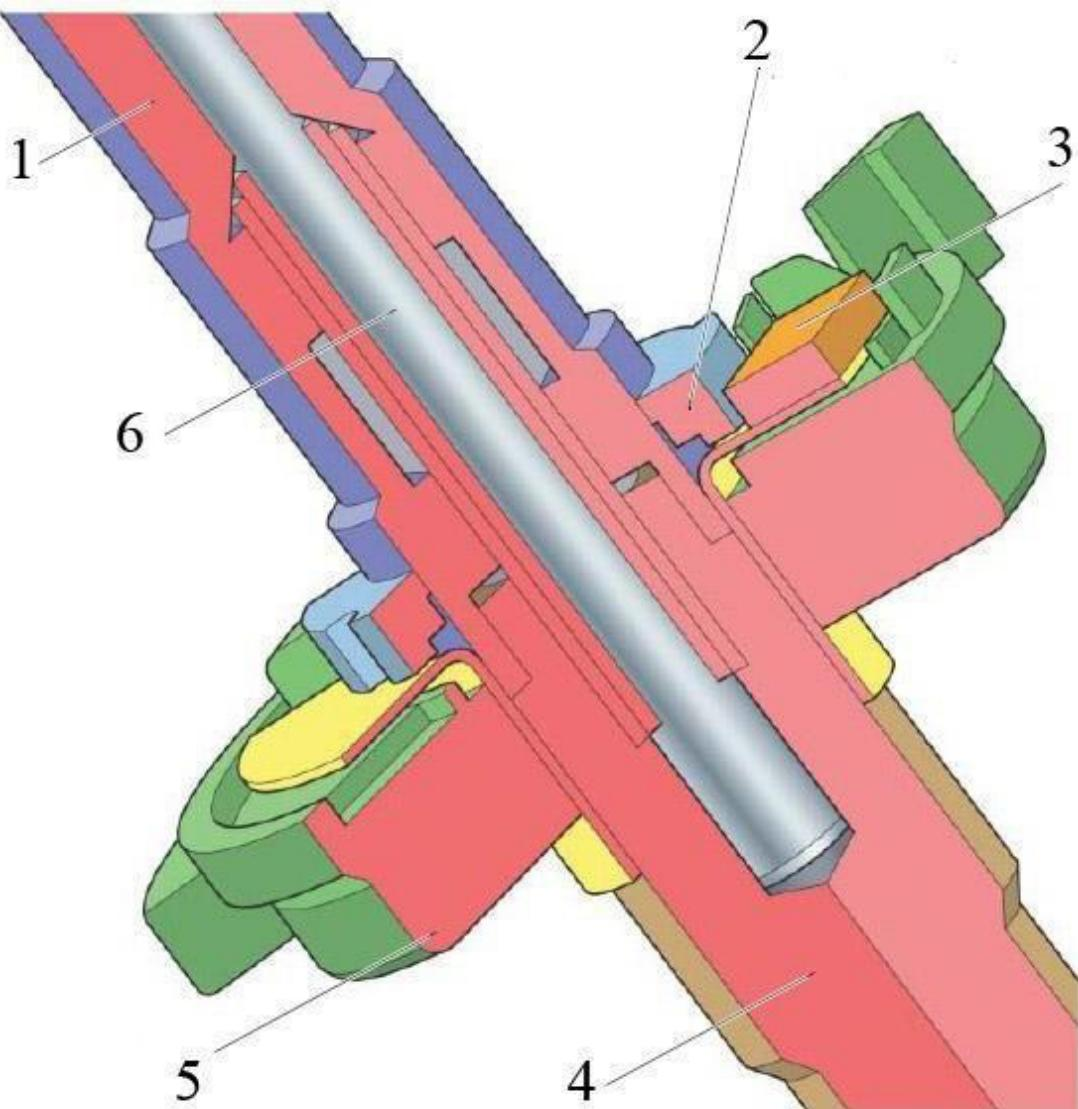
Рис. Датчик момента на рулевом колесе:
