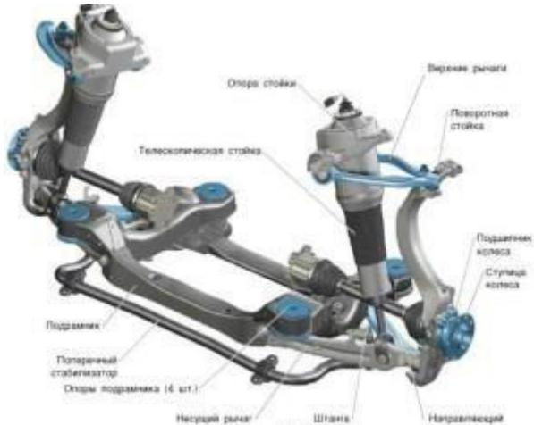
Основным несущим элементом подвески выступает подрамник, к нему фиксируются поперечные рычаги, соединенные с опорой ступицы, что в свою очередь обеспечивает ее поперечное положение. *Многорычажная задняя подвеска, которую устанавливают на современных автомобилях, состоит из трех или пяти поперечных рычагов.*
