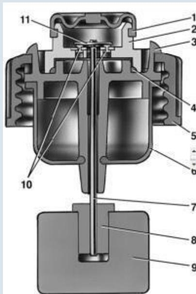
8.8. Датчик аварийного уровня тормозной жидкости:
