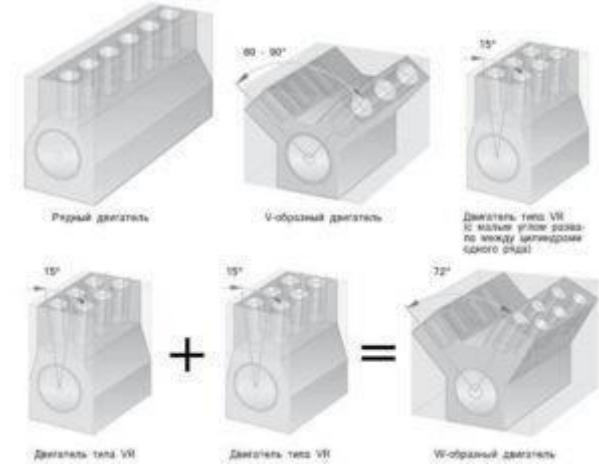
Наиболее распространенным среди V образных силовых агрегатов является двигатель V6.
