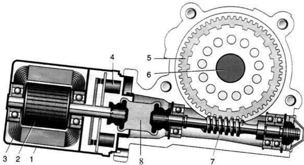
Рис. Разрез электроусилителя рулевого управления:
