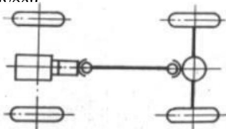
Три последних элемента на автомобилях классической компоновки объединяют в один агрегат, называемый ведущим мостом.
