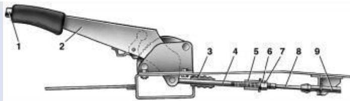
8.7. Привод стояночной тормозной системы: 1 – кнопка фиксации рычага; 2 – рычаг привода стояночного тормоза; 3 – защитный чехол; 4 – тяга; 5 – уравнитель троса; 6 – регулировочная гайка; 7 – контргайка; 8 – трос; 9 – оболочка троса
