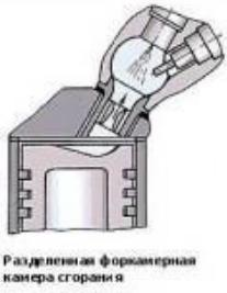
Другой вариант – разделенная камера, то есть камера, которая расположена не в цилиндре, а на входе к нему и связана с ними каналом. Топливо подается в камеру, где перемешивается с вихревым потоком воздуха, что лучше распределяет его капли по объему камеры сгорания и способствует полному его сгоранию. Такой вариант подходит для небольших установок и легковых автомобилей, но он значительно увеличивает расход топлива.
