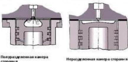
Неразделенная камера расположена в самой конструкции поршня или над ним, топливо на такте впуска попадает в нее, где и воспламеняется при
