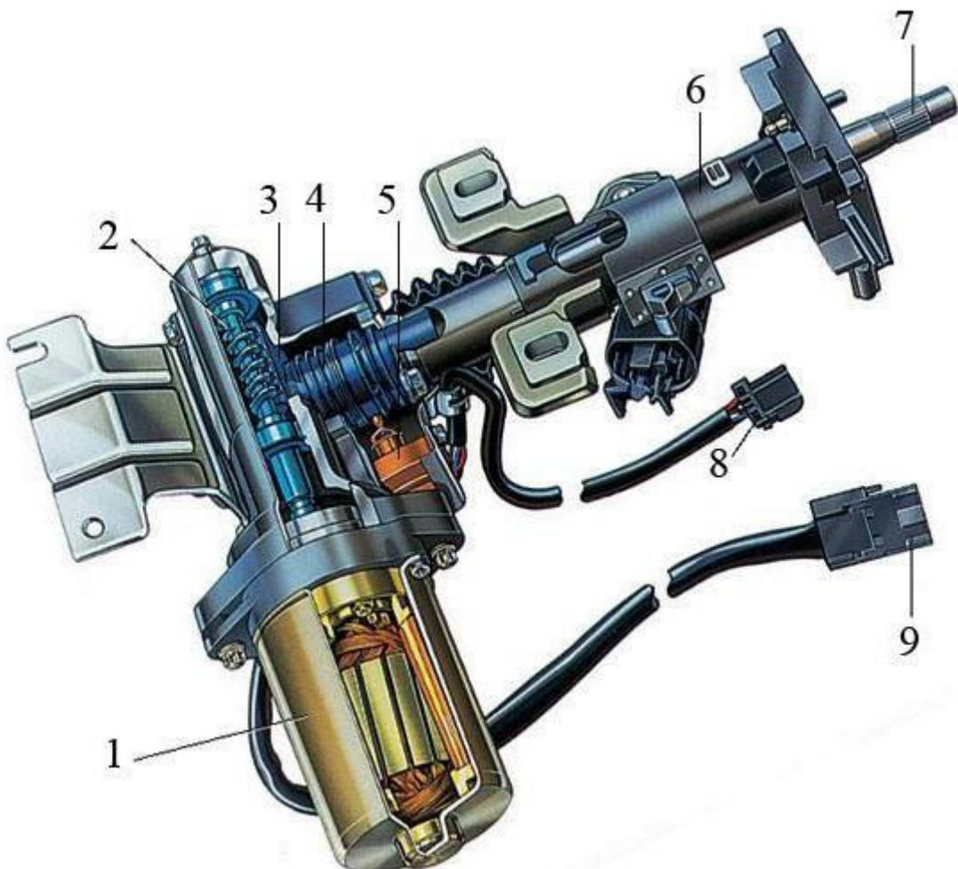
Рис. Электроусилитель рулевого управления на примере автомобиля Opel Corsa:
