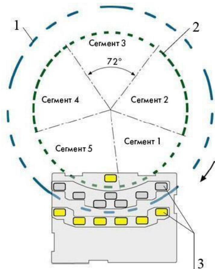
Рис. Схема датчика угла поворота рулевого колеса:
