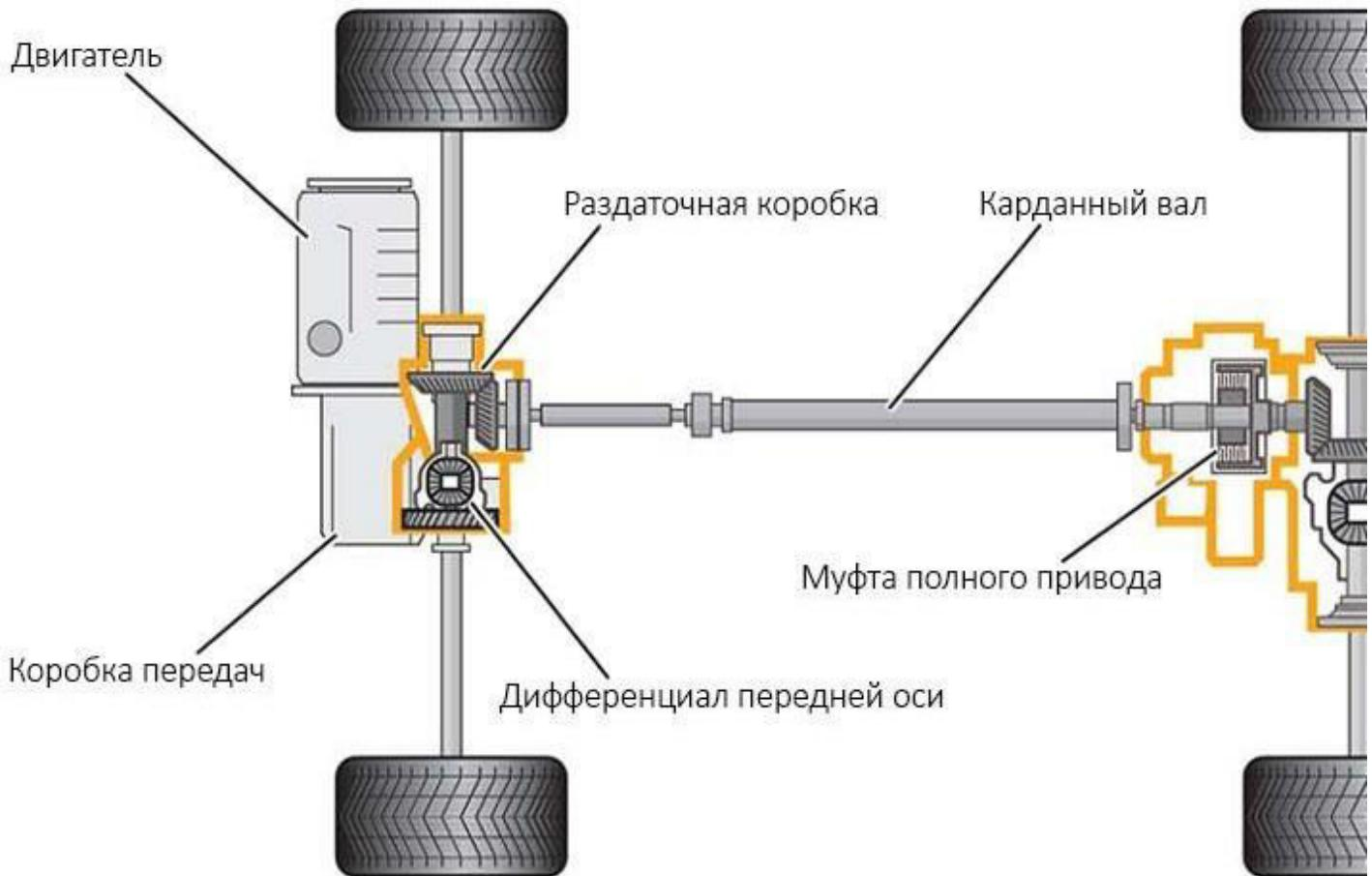
Несмотря на использование одних и тех же составляющих, вариаций и конструктивных исполнений трансмиссии – множество.
