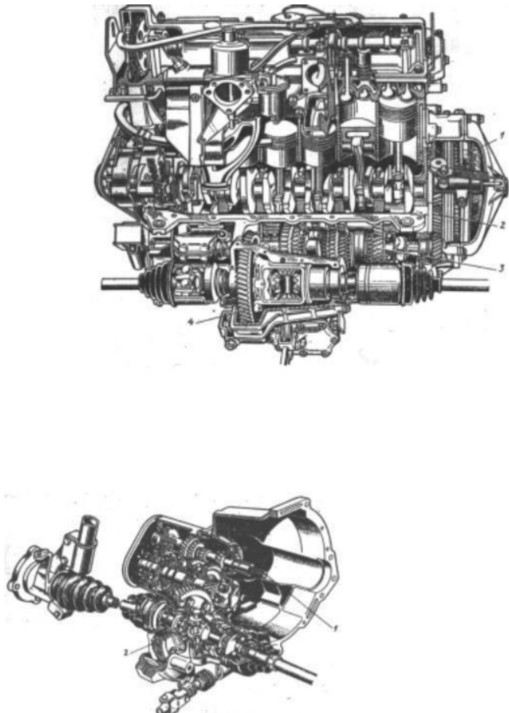
Рис. 5. Трансмиссия автомобиля, расположенная в отдельном картере: 1 – коробка передач, 2 – главная передача
