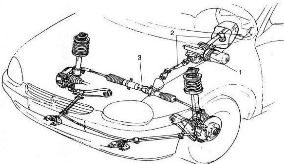
Рис. Общее расположение агрегатов рулевого управления с электроусилителем:
