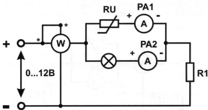
Рис. 3.3 Исследование нелинейной цепи постоянного тока
