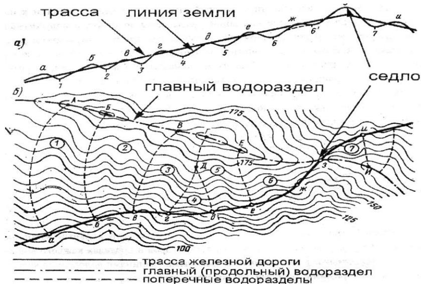
а - продольный профиль: 1 – 7 - точки размещения ИССО, а – и - водораздельные точки; б - план в горизонталях: цифры в кружках - номера бассейнов, соответствующие точкам размещения ИССО
