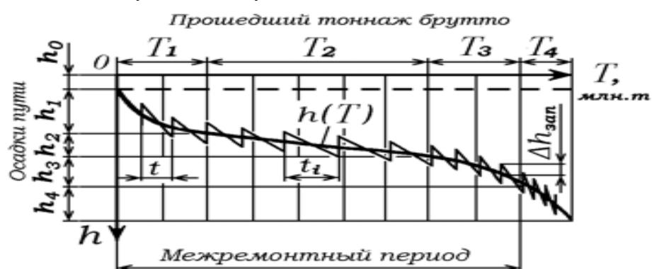
Рис. 4 График накопления остаточных осадок пути
