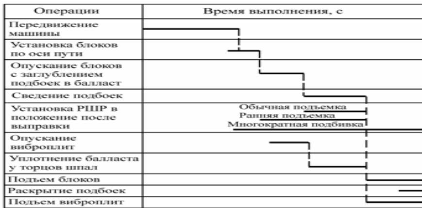
Рис. 10.34. Диаграмма времени выполнения операций рабочего цикла выправочно-подбивочной машины циклического действия
