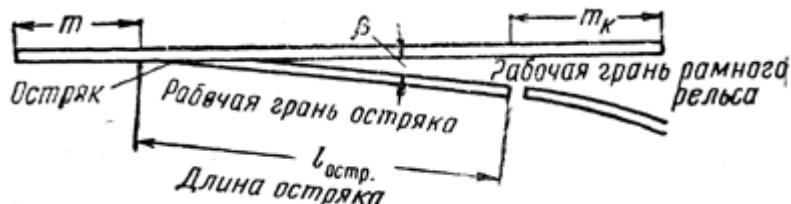
Рисунок 9 – Схема рамного рельса с прямолинейным остряком
