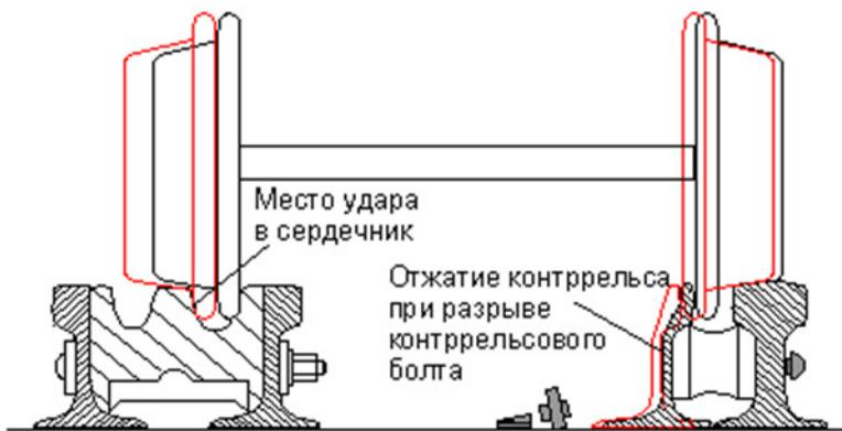
Рисунок 17 – Последствия разрыва контррельсового болта
