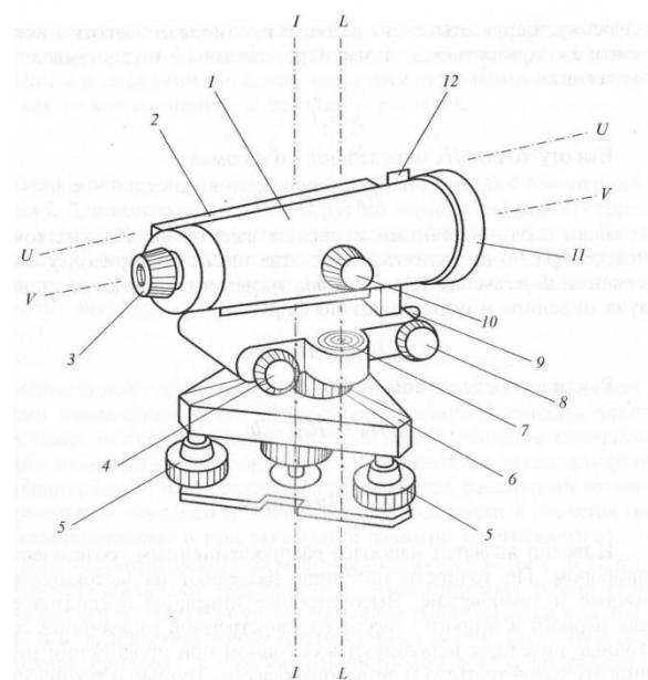
Принципиальная схема нивелира с цилиндрическим уровнем при зрительной трубе
