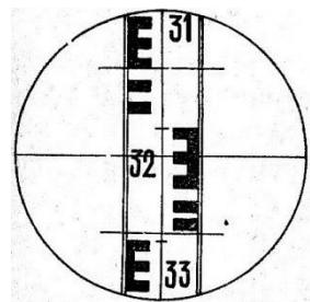
Поле зрения зрительной трубы в рабочем положении нивелира при наведении на красную сторону рейки.
